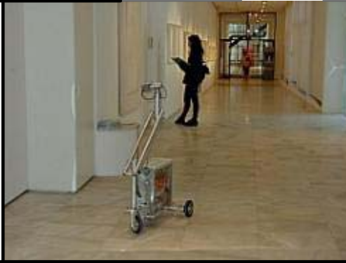
Πειραματικό τηλεκατευθυνόμενο όχημα για τη μέσω δικτύου περιήγηση του Μακεδονικού Μουσείου Σύγχρονης Τέχνης
